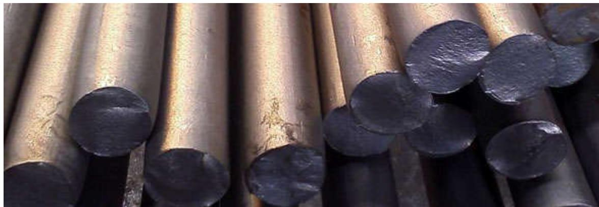
Izgled površine dobijene razdvajanjem lomljenjem
